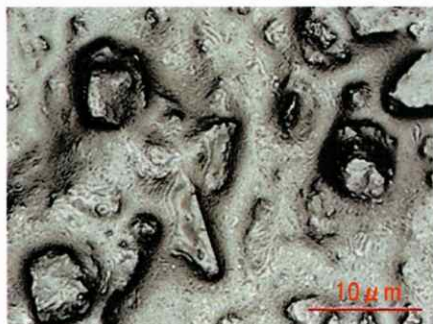
「従来成形機JIS試験片成形品」切断面 (溶融温度230℃)
