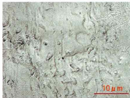
「モールドロック ® JIS試験片成形品」切断面 (溶融温度230℃)
